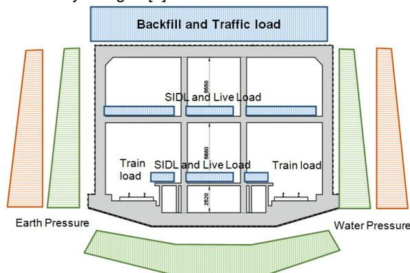
**Fig. 2. Loading Diagram.**
